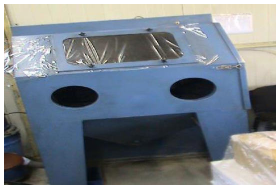
Instalația de sablare
