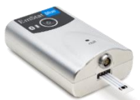
Exemplu de sistem portabil de spectroscopie prin impedanță electrochimică (PalmSense) cu celulă electrochimică pe substrat ceramic și electrozi obținuți prin screen-printing cu pastă carbonică.
